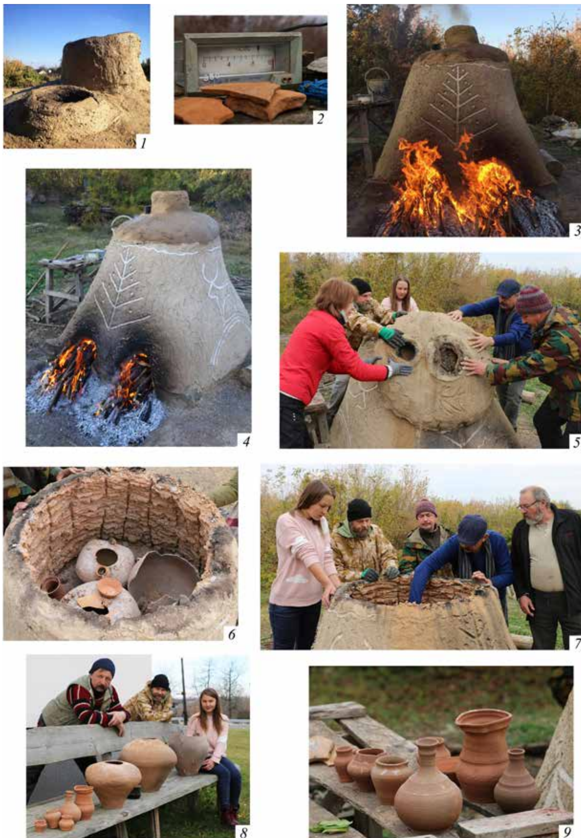
Рис. 4. Легедзине-2021, експеримент з будівництва та випробування «тальянківського горна»:
