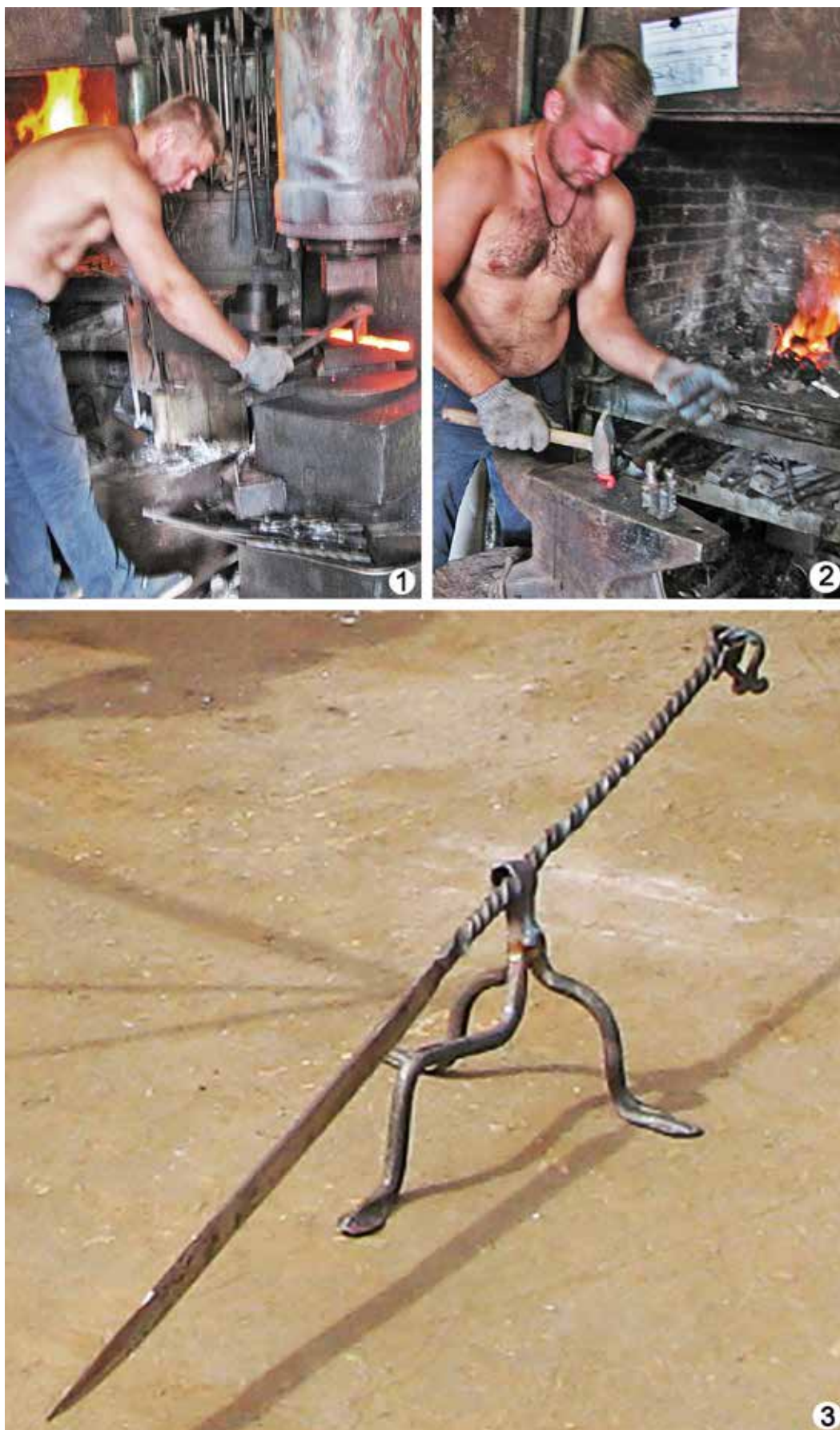
Рис. 5. Виготовлення моделі рожна. 1, 2 – процес виготовлення; 3 – готова модель
